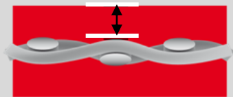
230 µm Technologie Serge Ferrari 650g/m 2
