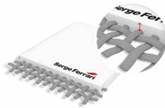
Matériaux Serge Ferrari : enduction de l'armature en fils polyester haute ténacité par des couches de polymères hautes performance
